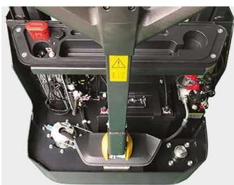
Le BMS "Battery Managing System" de la batterie contrôle les paramètres de charge et de décharge, la température de fonctionnement, les courts-circuits. La communication avec BMS et le réglage du logiciel est possible via CAN-BUS.
