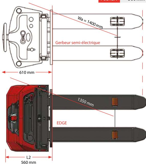
Nos ingénieurs ont élaboré un gerbeur beaucoup plus compact par rapport aux produits manuels et semi-électriques traditionnellement utilisés dans des camions, sans sacrifier la stabilité, la robustesse, la sécurité et le confort de fonctionnement.
