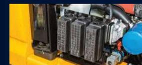
Tous les fusibles et relais sont centralisés dans trois boîtiers certifiés IP65 (protection renforcée contre la pénétration d'eau et de poussière). Pour un accès facilité, ces boîtiers sont placés sous le capot moteur.
