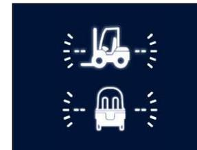
Pendant la conduite, l'unité de commande machine (MCU) détecte les mouvements [longitudina] et [latéral] et **alerte l'opérateur en cas de dépassement des valeurs de stabilité prédéfinies.**
