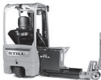
3) Remplacement avec un transpalette manuel standard, un transpalette bas ou un bâti d'échange de batterie.
