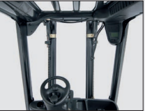
Conception de mât Fenwick → Excellente visibilité sur la charge et son environnement à travers les montants étroits du mât → Capacité nominale conservée à grande hauteur → Capacité résiduelle importante → Excellente stabilité de la charge
