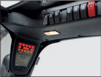
Gestion de l'énergie → Pompe de levée hydraulique : une productivité maximale et une consommation d'énergie réduite → ECOMode : chaque mode adapté pour chaque application → Prise diagnostique à portée de main, facilité de maintenance
