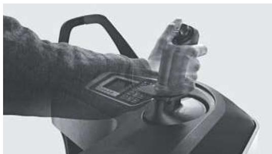
Enchaînement précis de mouvements de traction, de levée et descente sans changement de position grâce au joystick de série
