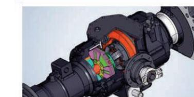
L'utilisation de freins à disque humides scellés garantit non seulement des performances de freinage stables, mais réduit également les coûts de maintenance d'environ 69 %.
