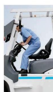
Équipé d'un mécanisme de verrouillage qui autorise les opérations de déplacement et de chargement/déchargement uniquement lorsque l'opérateur est en position de travail correcte. Ce dispositif de sécurité prévient les accidents causés par une position instable ou un dysfonctionnement.
