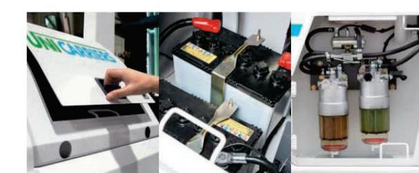
Les capots latéraux du véhicule peuvent être ouverts et fermés d'une simple pression, et à l'intérieur des capots, les composants électriques tels que les fusibles et les boîtiers de relais, les systèmes de carburant tels que la pompe à carburant et le filtre à carburant, ainsi que la batterie sont tous concentrés, ce qui facilite l'entretien.
