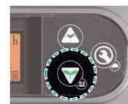
Réduisez la consommation de carburant En optimisant le régime moteur maximal et l'accélération, vous pouvez sélectionner le mode ECO, qui réduit la consommation de carburant jusqu'à 11 % par rapport au mode standard. (Comparaison avec notre test de cycle de travail)
