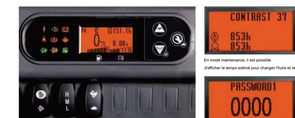
En mode maintenance, il est possible d'afficher le temps estimé pour changer l'huile et les filtres.
