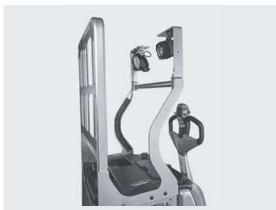
Sécurité maximale lors du chargement et du déchargement des camions grâce à l'éclairage de sécurité Safety Light et à des projecteurs orientables
