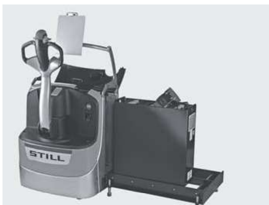
Disponibilité maximale grâce au changement latéral de batterie
