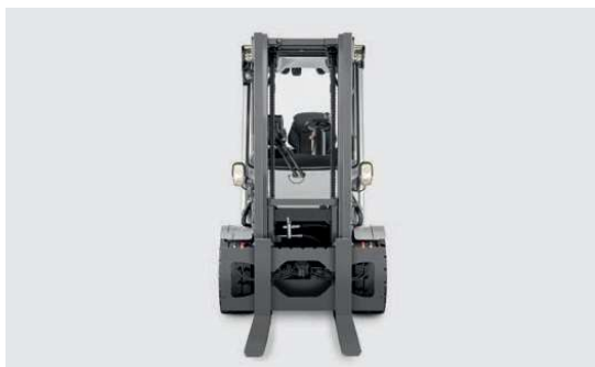
Sécurité maximale de manipulation des charges grâce à un profilé de mât assurant une vue dégagée sur les fourches et l'environnement du chariot
