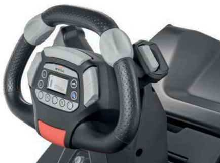
Translation et levage simultanés avec les commodos STILL Easy Move en option
