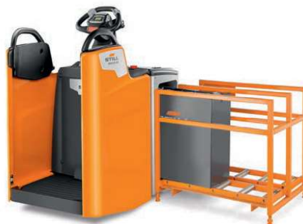
Disponibilité maximale du chariot grâce au changement latéral de batterie ou à la technologie lithium-ion permettant une recharge par opportunité
