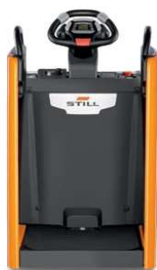
Sécurité au travail et productivité garanties grâce aux parois latérales robustes et à une vitesse de translation maximale de 14 km/h
