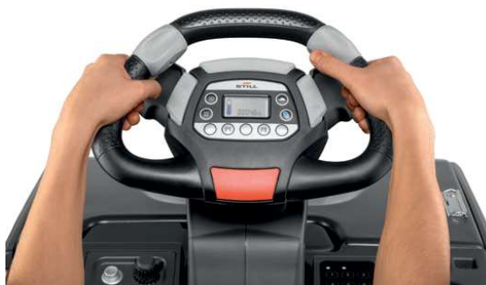
Grâce au volant STILL Easy Drive réglable en hauteur, toutes les fonctions peuvent être utilisées à l'aide des éléments de commande ergonomiques sans que les droitiers et les gauchers aient à passer la main de l'autre côté pour les saisir dans
