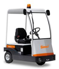
Tracteur à 3 roues, «homme à bord», avec traction arrière. Extrêmement compact et maniable, idéal pour tous les services industriels - même en plein air. Hauteur avec toit de protection extrêmement limitée pour travailler également dans les tunnels ou en présence de portails à hauteur réduite.
