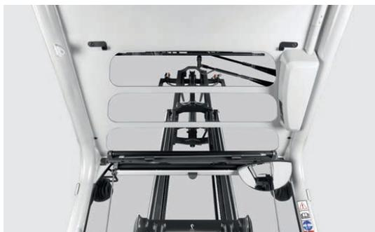
Haute précision et sécurité des prises et déposes de charges grâce à un contrôle visuel optimal vers l'avant et en hauteur
