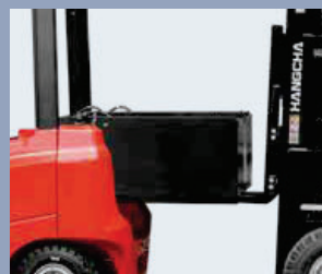
La batterie peut être retirée par l'arrière pour son remplacement (uniquement sur la version batterie au plomb)
