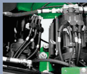
Traction et levage adoptent des moteurs synchrones à aimants permanents grâce au contrôleur Enpower.
